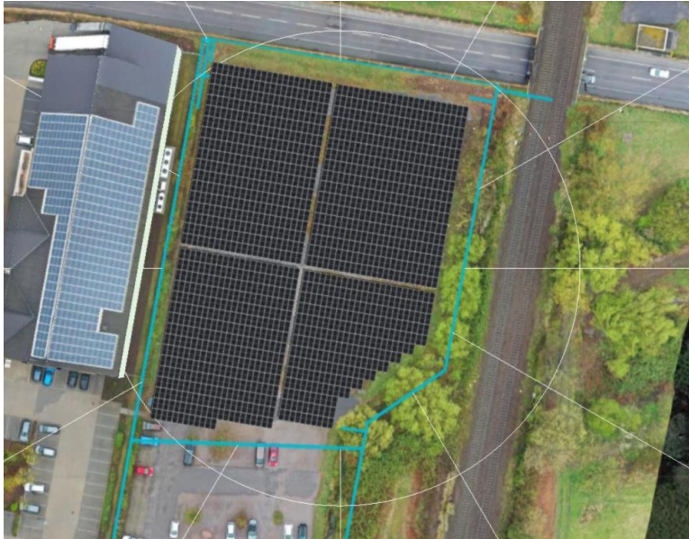
Abbildung 4: Modulbelegungsplan der PV-Freifläche 3 (Quelle: Auftraggeber)
