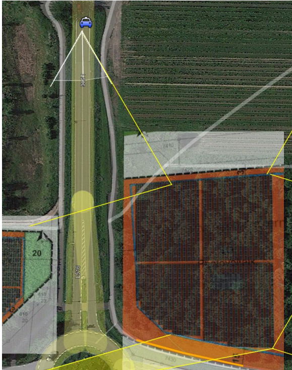
Abbildung 22: Relevanter Sichtwinkel des Straßenverkehrs der L516, Emissionswinkel möglicher Reflexionen von der Modulfläche in gelb (Quelle: Google Earth)
