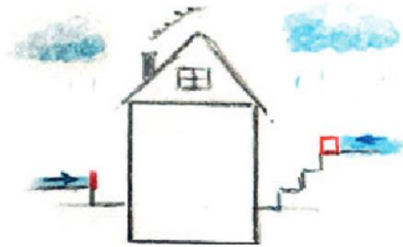
Abbildung 22 Schutz tiefliegender Gebäudezugänge [8]
