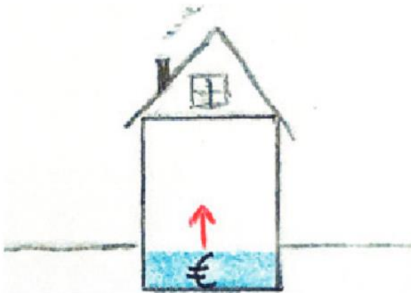
Abbildung 28 Hochwasserangepasste Nutzung tiefliegender Räume [8]
