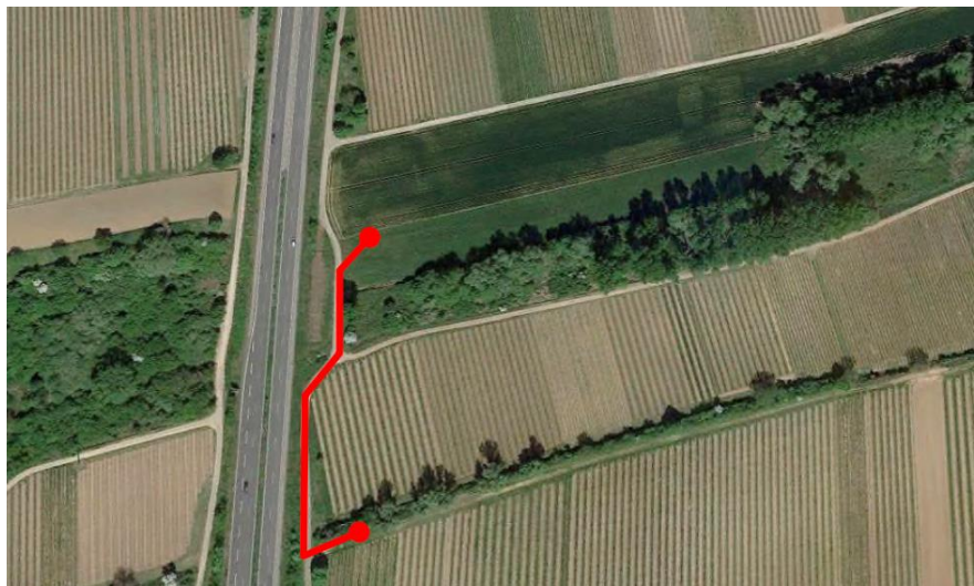
Bild 8 Einspeisepunkt und Kabeltrasse
